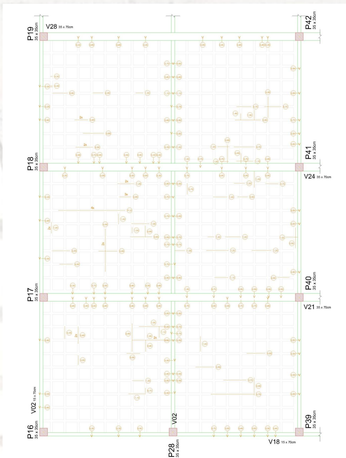
Figura 23 - Identificação dos pontos de fissuração e medidas das suas aberturas (lajes da escada e do auditório).
