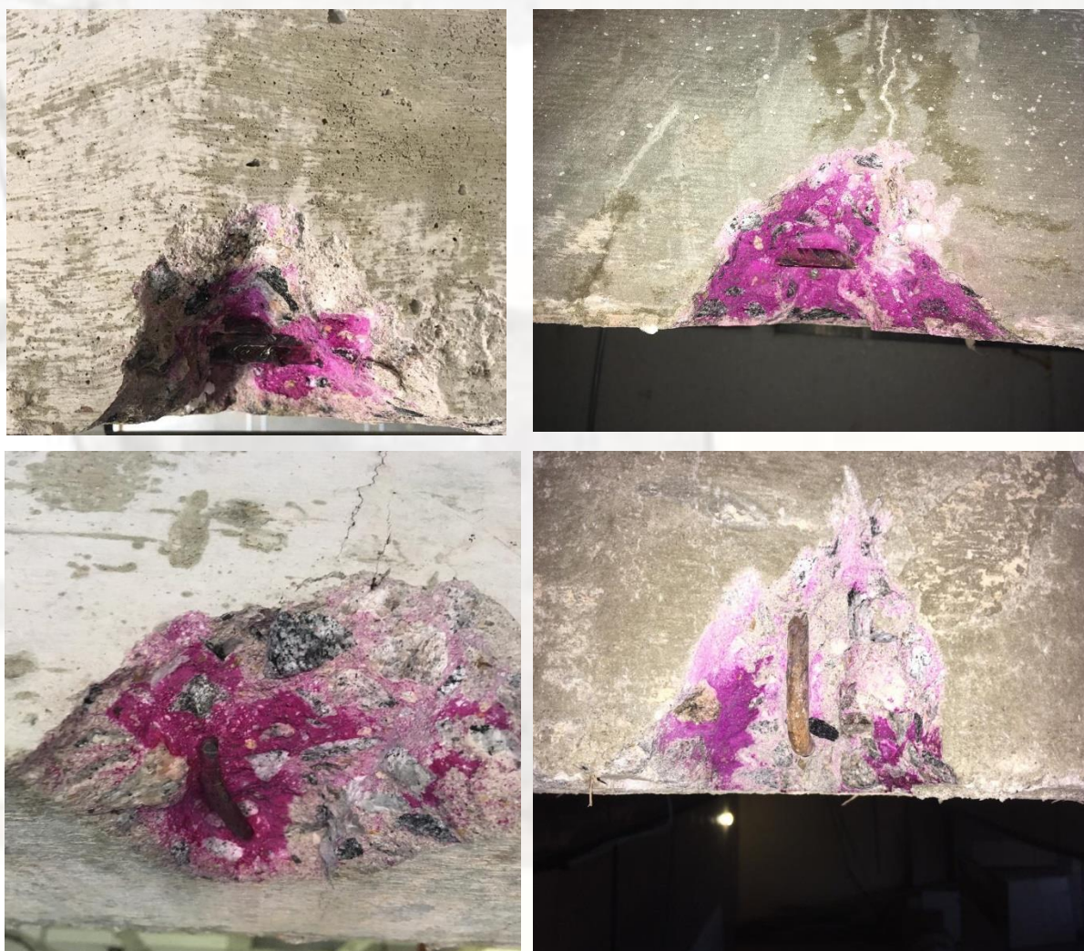
Figura 30 – Medidas da profundidade de carbonatação em vigas.
